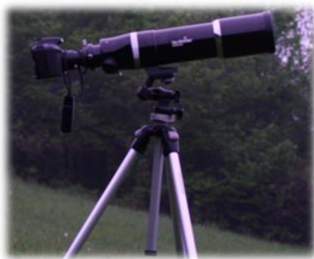
In questa immagine si può osservare la Canon 30D al fuoco diretto del rifrattore Apo a cui è stato alloggiato un filtro spettroscopico Baader a 207 linee/mm.
